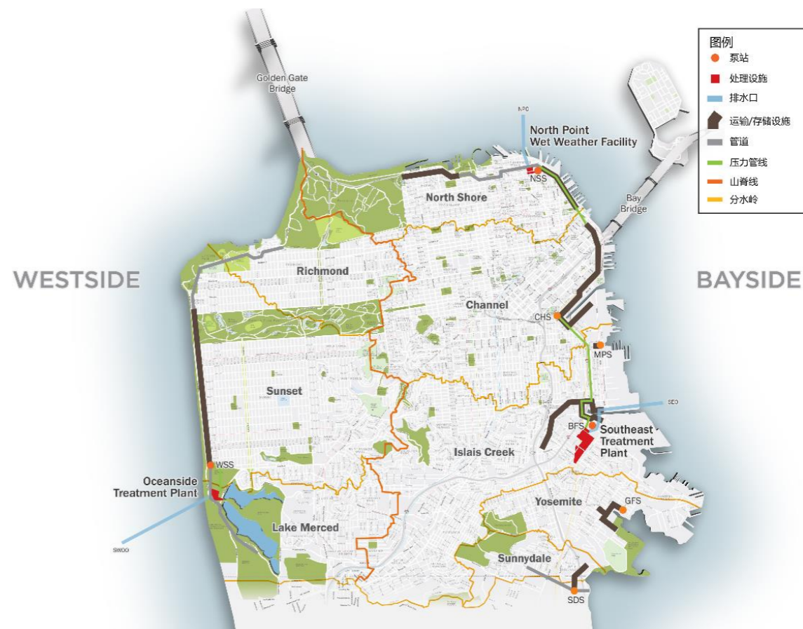
图 4.1-2 旧金山市污水、雨水处理系统
